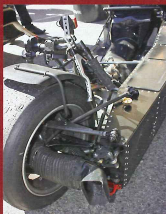
Monocoque-Chassis, Achsschenkel lenkung und fast senkrechte Positionierung der Lenkerstummel.
