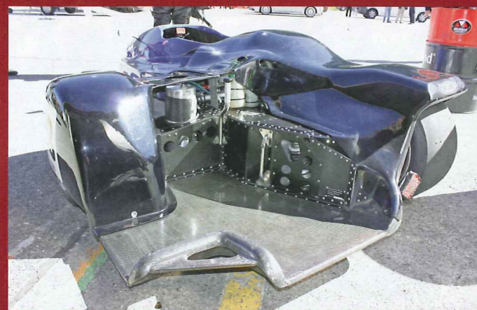
Plampi-Arbeitsplatz: Der Haltegriff in der vorderen Ecke wird nie losgelassen. Am Plattformrand wird mit den Füßen abgestützt.
